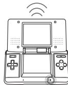
電源ランプが変速点滅しているときは、ワイヤレス通信機能がONになっています。
